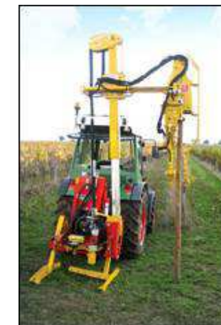
Photo 44 : Exemple d'enfonce-pieux (source : Rabaud SARL)
